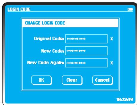
Utilizando el teclado, introduzca el código y seleccione **OK**. Si hace un error, se visualiza una 'X' en el lado derecho de la ventana de código. Utilice el botón **Clear (Eliminar)** para borrar las entradas.
