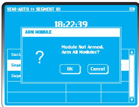
Habiendo transmitido los datos de lanzamiento, si la LLAVE DE ACTIVACIÓN está ajustada a la posición **Off**, el sistema indica “Turn Arm Key On” (Gire la llave de activación hasta la posición **On**) en la pantalla de lanzamiento.
