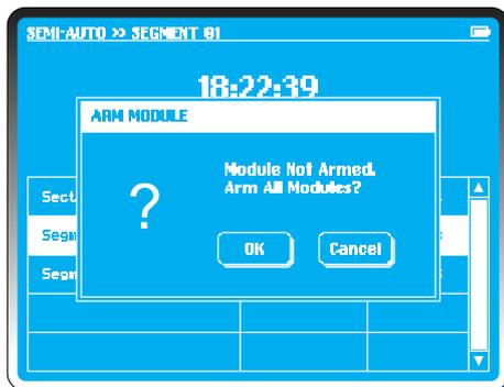
PyroSure se comunicará con los módulos para comparar la secuencia de lanzamiento cargada con la información en tiempo real de todos los módulos de los fuegos artificiales. Describimos esto como el proceso de “ajuste”. Al igual que con la instalación de cualquier espectáculo, puede haber errores de continuidad; los canales que faltan se resaltarán.
