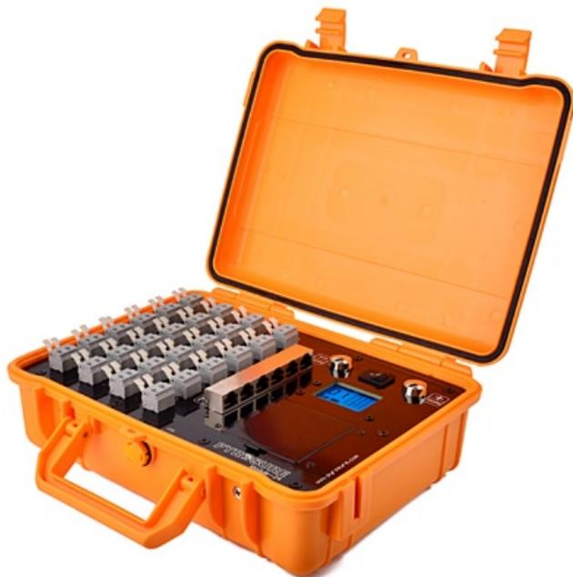
Il **Modulo-24** consiste in un modulo wireless e 24 cariche all'interno di un contenitore in ABS. L'unità ha uno schermo LED per controllare il livello della batteria, la forza del segnale e le informazioni sulle cariche.
